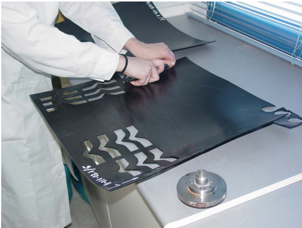
Fig nº 8. Confección de muestras para tracciones longitudinales y transversales
