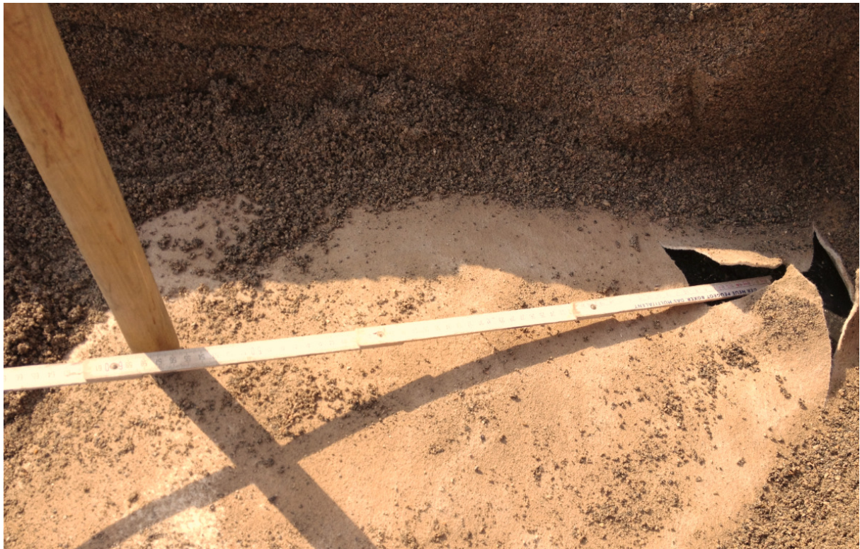
Figura 12: el mango de la pala a la izquierda indica el lugar donde se había empezado a excavar; el agujera de la geomembrana se encuentra al inicio del metro plegable.
